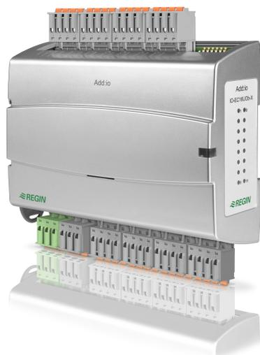
Модули дополнительных входов/выходов для контроллеров EXOcompact и EXOclever, каждый из которых несет 16 дополнительных I/O. Это дает возможность **неограниченного** наращивания контроллеров EXOclever и подключения до 50 дополнительных I/O к контроллерам EXOcompact. Модули могут устанавливаться вплотную один к другому, занимая минимум места.
