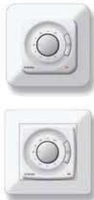
Электронный 1-ступенчатый термостат с переключателем Вкл/Выкл, предназначенный для внутреннего настенного монтажа. Он комплектуется напольным датчиком и имеет один вход для внешнего датчика температуры. Также имеет ограничение по минимальной температуре и функцию ночной перенастройки температуры. Они бывают двух внешних видов.
