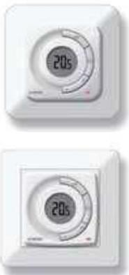
Электронный 1-ступенчатый термостат с дисплеем и переключателем Вкл/Выкл, предназначенный для внутреннего настенного монтажа. Термостат имеет недельный планировщик с режимом энергосбережения. Он комплектуется напольным датчиком и имеет один вход для внешнего датчика температуры. Также имеет ограничение по минимальной температуре и функцию ночной перенастройки температуры. Они бывают двух внешних видов.
