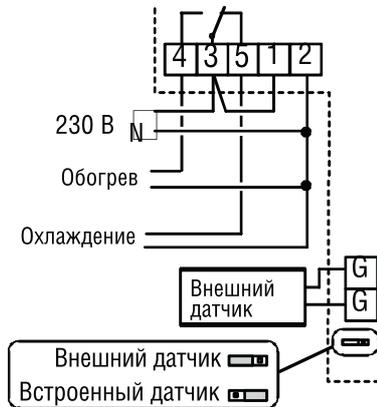
Термостат может использоваться для регулирования обогрева или охлаждения, но не одновременно для того и другого.
