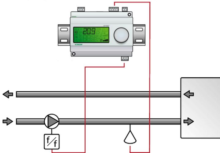
Значение давления считываемое датчиком давления сравнивается с уставкой, для формирования управляющего сигнала, который подается на выход АО1. Сигнал с АО2 является инверсным к сигналу АО1.
