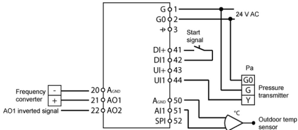
**Расчетная уставка.** В режиме работы 5, регулирование давления в воздуховоде с компенсацией по наружной температуре, контроллер не работает с фиксированным значением уставки. Вместо этого он работает в расчетном режиме, при котором уставка изменяется в зависимости от значения внешней температуры, при этом уставка будет отображаться на дисплее при поворачивании управляющей кнопки за часовой стрелкой.
