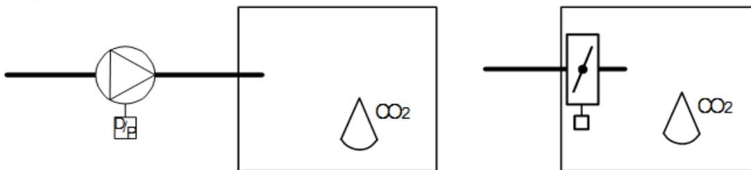
Сигнал на выходе растет, когда содержание CO<sub>2</sub> превышает уставку. Датчик углекислого газа должен иметь выход 0...10V.
