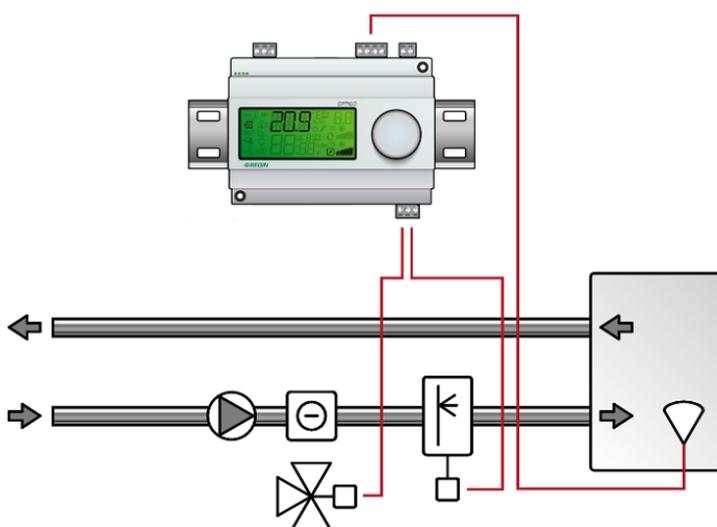
Считываемое значение влажности сравнивается с уставкой, для формирования управляющих сигналов, подающихся на выходы AO1 или AO2. Выход AO1 используется для увлажнения, а выход AO2 – для осушения. Данный режим контроля можно применять только как информативный или как вспомогательный в основной системе поддержания параметров воздуха.
