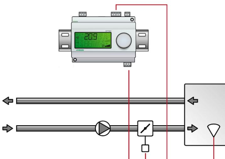
Значение содержания CO2 в воздухе, измеряемое датчиком, сравнивается с уставкой.
