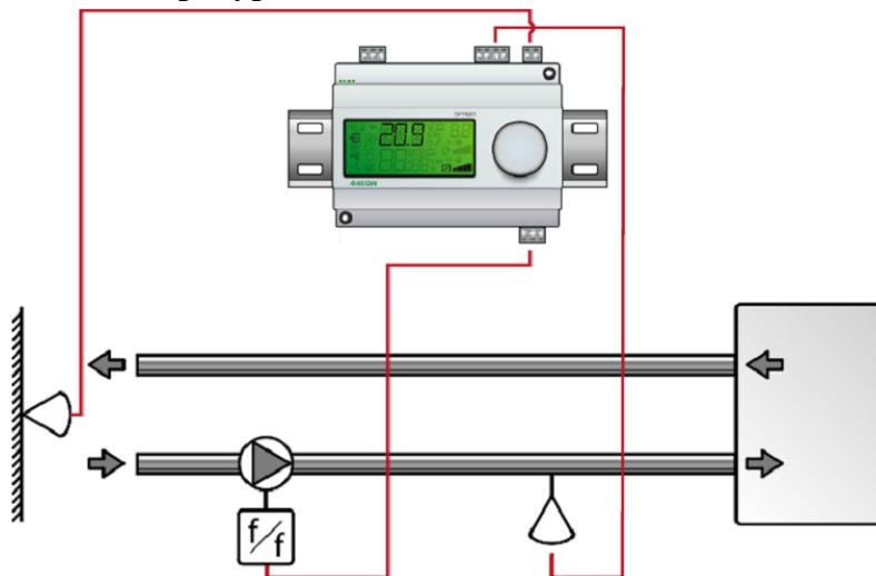
Значение давления считываемое датчиком давления сравнивается с уставкой, для формирования управляющего сигнала, который подается на выход АО1. Уставка корректируется в зависимости от внешней температуры. Используется ПИ-регуляция.
