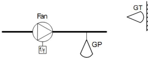
Выходной сигнал возрастает, когда датчик давления выдает значение ниже уставки. Уставка давления в каналах корректируется в зависимости от внешней температуры Датчик давления должен иметь выход 0...10В.
