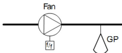
Выходной сигнал возрастает, когда датчик давления выдает значение ниже уставки. Датчик давления должен иметь выход 0...10В.
