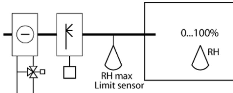
В этом режиме работы Optigo может управлять как увлажнением, так и осушением. Нейтральная зона устанавливается между увлажнением и осушением. Датчик влажности должен иметь выход 0...10В.
