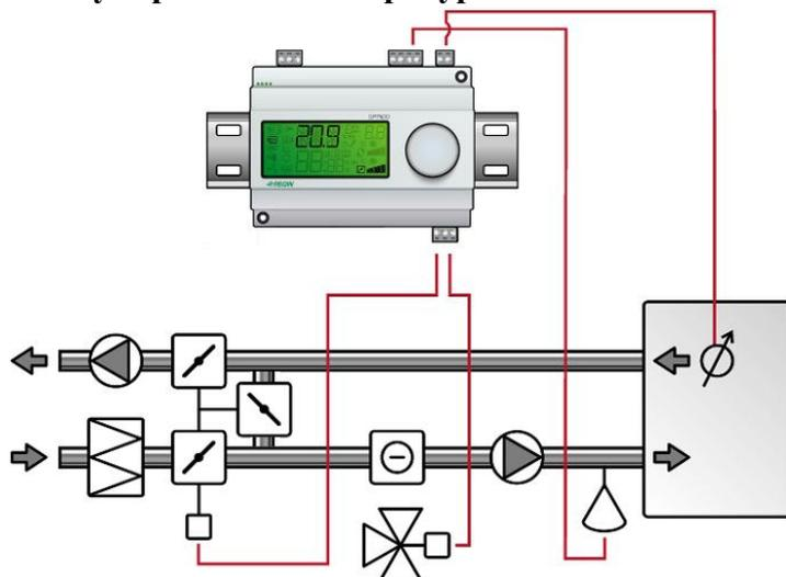
Измеряемая датчиками температура сравнивается с уставкой, для формирования управляющих сигналов на выходы AO1 и AO2. Используется ПИ-регуляция.
